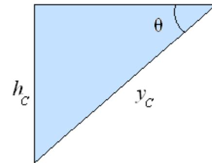
► A intuição sugere que a direção de ação da força resultante deveria passar pelo centróide da superfície. **Mas isso não acontece.**
