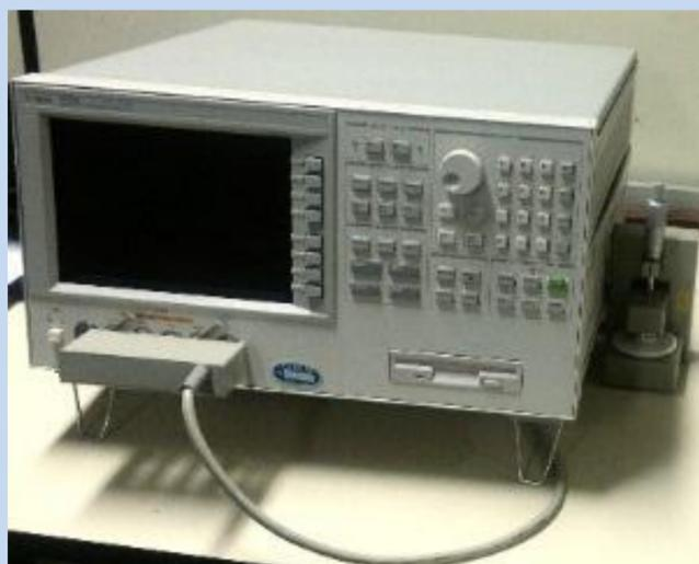
Figura 2: Medidor de Impedância
